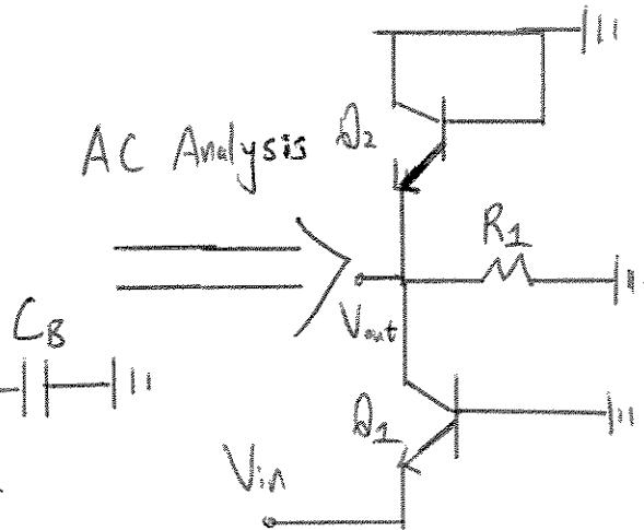
$$R_{out} = \frac{1}{g_m} // r_{\pi_2} // R_1 \approx \frac{1}{g_m} // R_1$$
