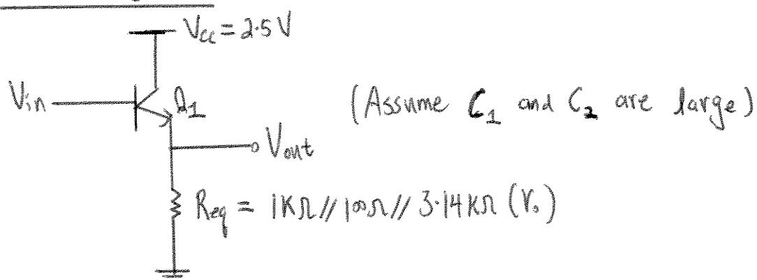
$$A_v = \frac{(1\text{ k}\Omega // 100\Omega // 3.14\text{ k}\Omega)}{16.34\Omega + (1\text{ k}\Omega // 100\Omega // 3.14\text{ k}\Omega)} = 0.84$$
